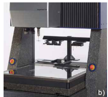
適用於任何應用的 WMS Multisensor 多測頭更換技術採用新的 transmitted light concept
