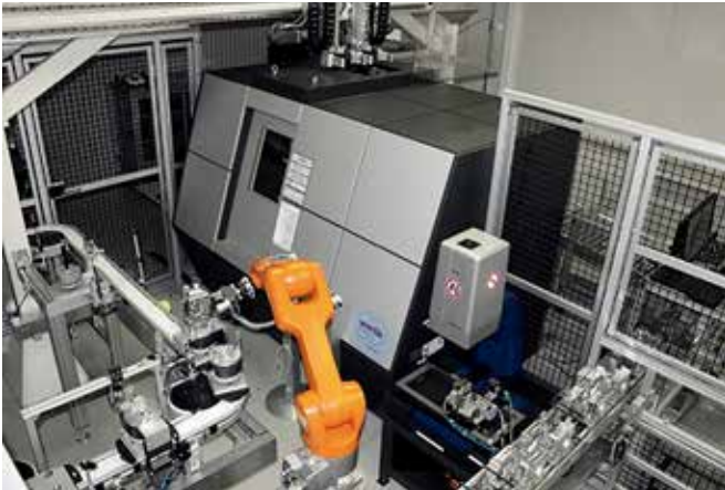
在德國馬牌 Continental 鋁件 ON LINE 量測單元中，使用 TomoScope L 和 ScopeCheck S 量測並檢查生產週期中是否存在缺陷
